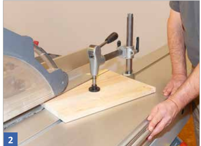
2 Spannen eines Werkstücks ohne Anschlag
