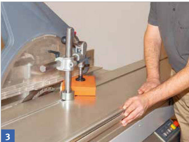
Schablonensägen mit Spannvorrichtung
