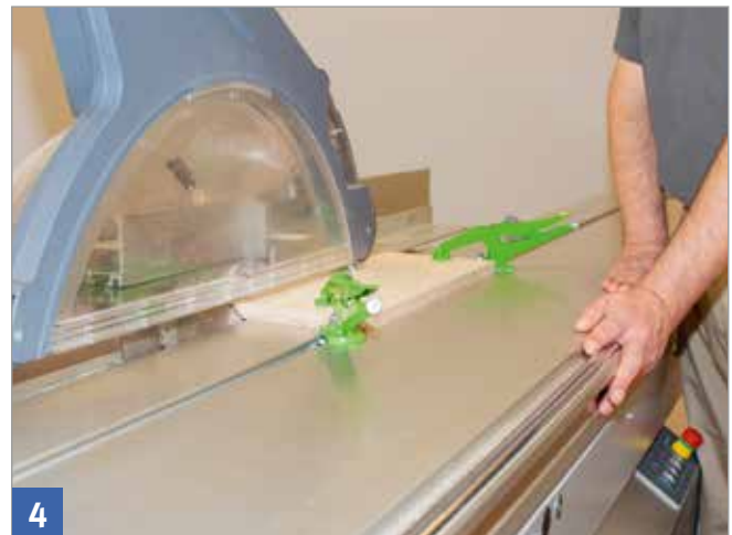
Schablonensägen mit Spannvorrichtung
