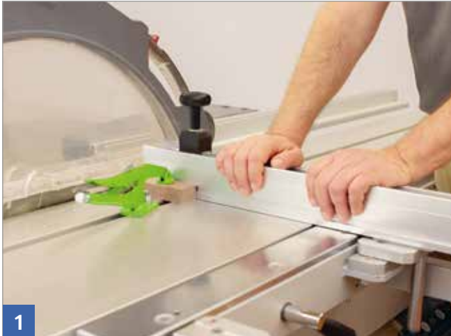
1 Spannen eines kleinen Werkstücks vor dem Queranschlag
