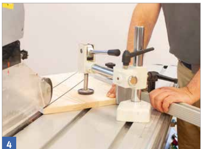
3 Spannen eines Werkstücks zum Winkelsägen
